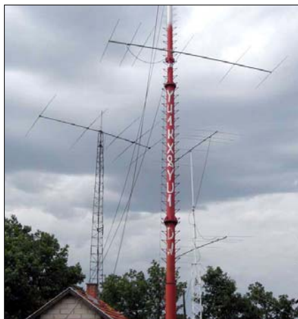
Slika 3. Za glavni sistem smo postavili 2x6el sistem na novom stubu, koji je na Vladinoj lokaciji doživeo promociju
